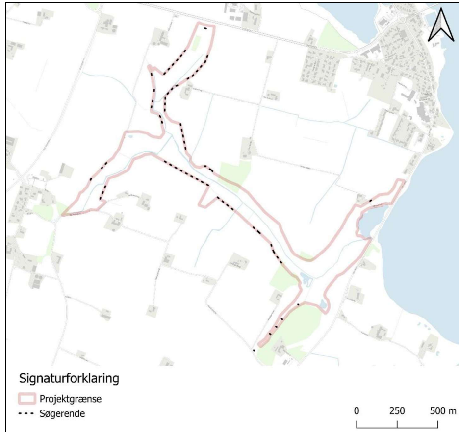
Figur 3-11 Kort over de planlagte steder, hvor der laves søgerender efter kendte og ukendte dræn. Ved enkelte prikker på kortene, er søgerenden kort, da der kendes umiddelbar placering af drænrør.
